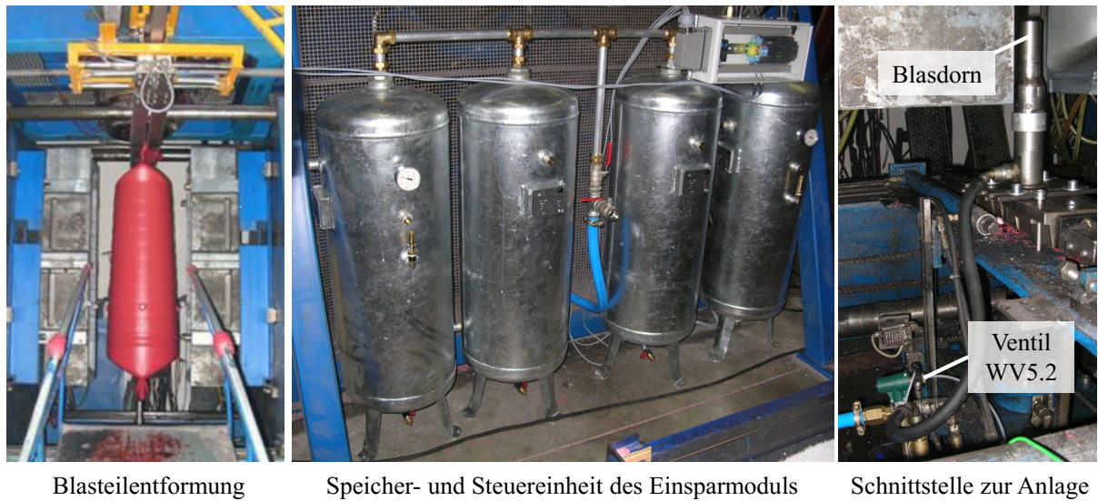
Abbildung F.4: Blasformanlage zur Herstellung der Bauschuttrutsche mit Einsparmodul ausgerüstet [132]
