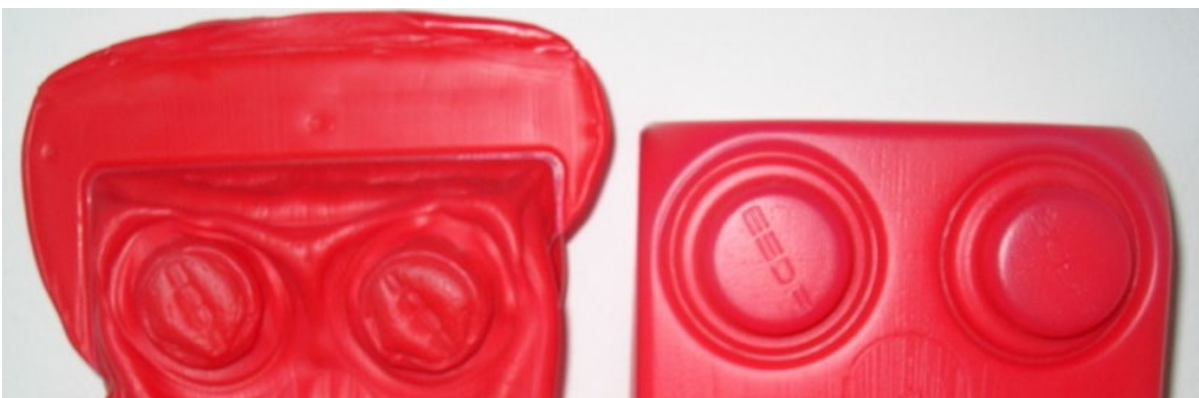
Abbildung 5.17: Umformgrad des Spielbausteins nach dem Vorformprozess (links) im Vergleich zum vollständig umgeformten Blasteil (rechts)
