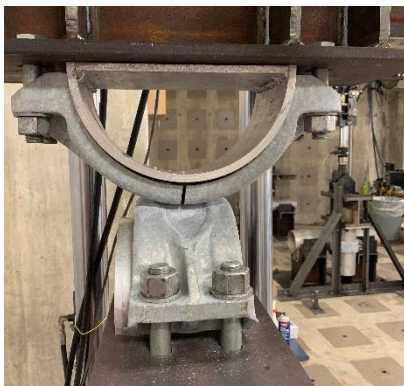
(a) Failure of FAT-TENS11
