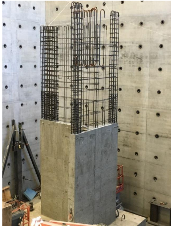
(d) Lift 2 steel cage
