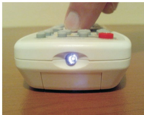
Zdjęcia pilota do telewizora wykonane aparatem z matrycą CCD. Na prawym zdjęciu widać świecącą w podczerwieni diodę LED
