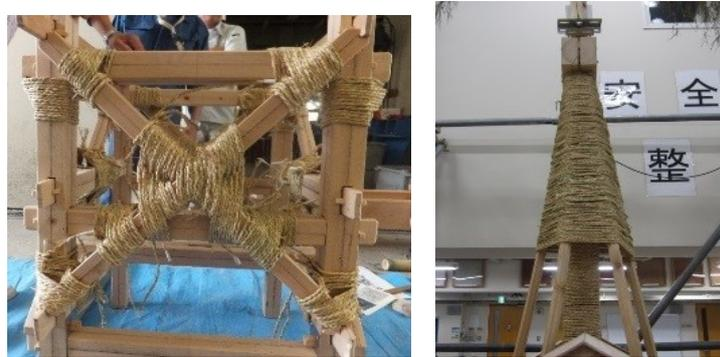
写真 5.3 試験体の縄がらみ
