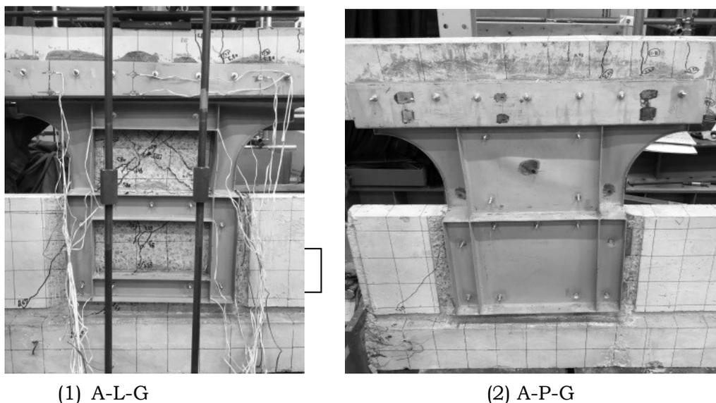
写真 4.1 実験終了時の鉄骨補強材の状況
