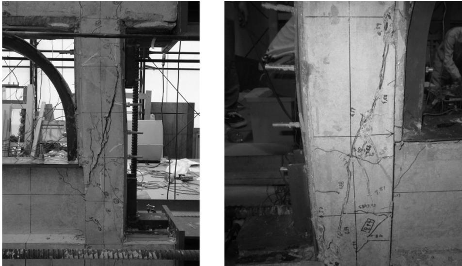
写真 2.6 実験終了時の柱のひび割れ状況 (左 : R1、右 : R2)
