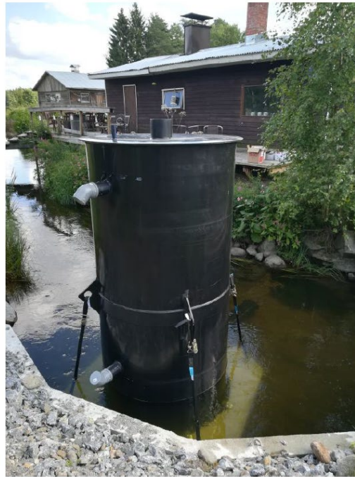
Kuva 3. Happi voidaan liuottaa paineistetussa tilassa tai valuttamalla. Kuva: Martti Naukkarinen.
