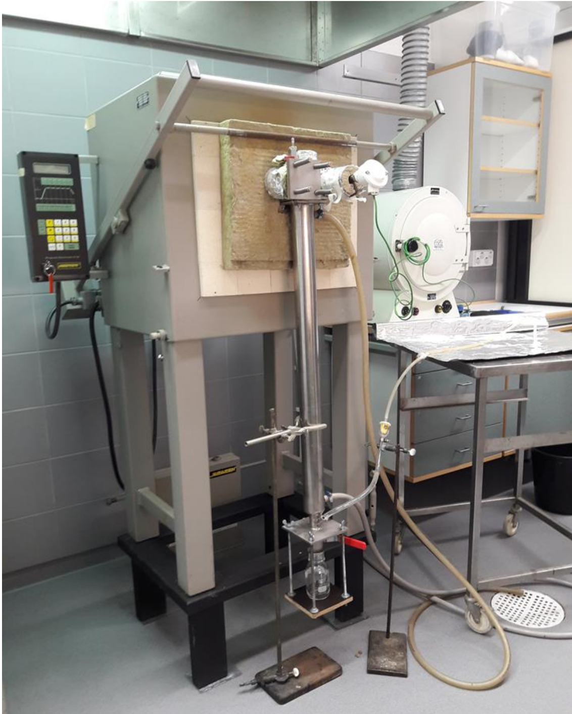
Kuva 1. Tutkimuksessa käytetty laboratoriomittakaavan pyrolyysilaitteisto. Kuva: Johanna Nikama, Luke.
