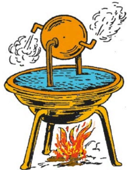
Figuur 1: Principetekening volgens Heron (10-70 na Chr.). (Foto : Stoom, verleden en toekomst)
