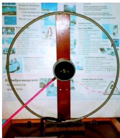
Рисунок 1 – Індукційний перетворювач для вимірювання імпульсного магнітного поля
