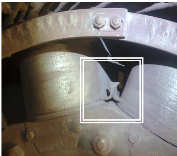
Рис. 1 – Міжполюсна перемичка обмотки збудження синхронної машини
