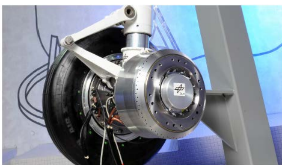
Рисунок 5.2 – Демонстраційний стенд електроприводу колеса, розроблений німецьким аерокосмічним центром
