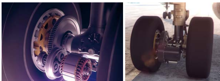
Рисунок 5.3 – Електропривод колеса шасі від Холдингу «Технодінаміка»
