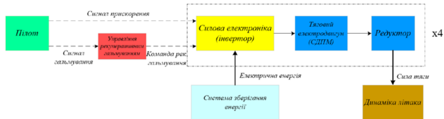
Рисунок 4.4 – Імітаційна модель системи електричного руління
