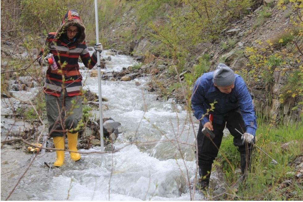
Şekil 10. Dere şev yüksekliklerinin mira kullanılarak ölçümü; bu ölçümler her transekt noktasında sağ ve sol dere şevleri üzerinde gerçekleştirilmiştir.
