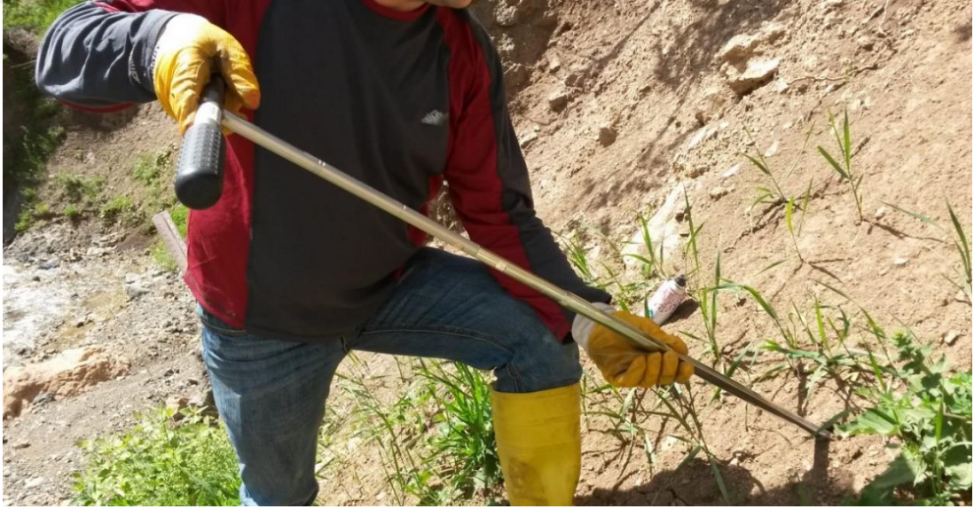
Şekil 9. Şev toprak hacim ağırlıklarının belirlenmesi için dere kenarlarında yapılan toprak örnekleme.
