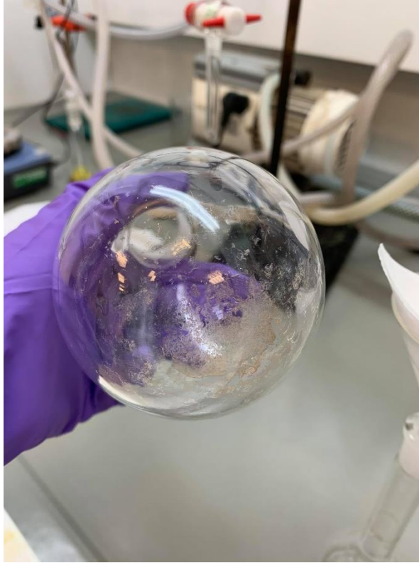
Slika 4-8. Priprava vzorcev za določanje vsebnosti aescina : kristali, ki so se formirali po vakuumskem uparjanju
