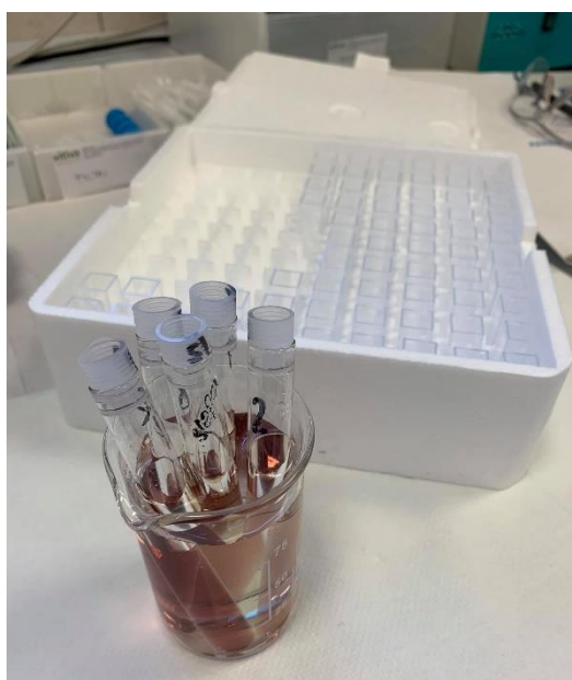
Slika 4-11. Ohlajanje končnih vzorcev pred merjenjem s spektrofotometrom in kivete za enkratno uporabo
