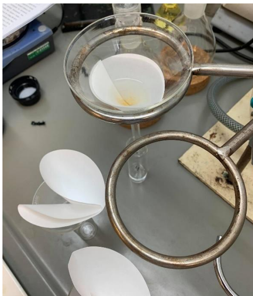
Slika 4-9. Priprava vzorcev za določanje vsebnosti aescina : izpiranje vzorca z dietil etrom skozi filter papir
