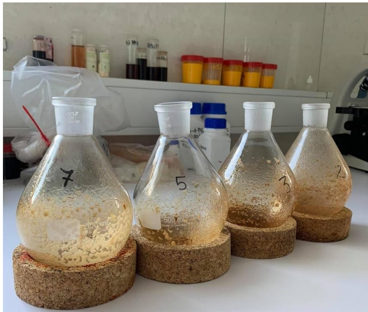
Slika 4-4. Produkti ekstrakcije po vakuumskem uparjanju in pred vakuumskim sušenjem
