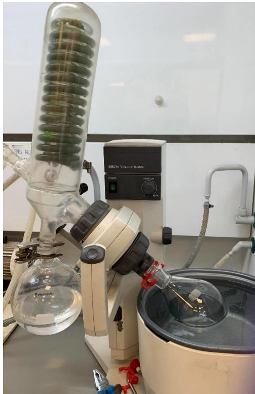
Slika 4-7. Priprava vzorcev za določanje vsebnosti aescina : vakuumsko uparjanje v sklopu določevanja vsebnosti aescina v ekstraktih
