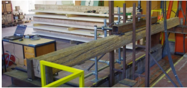
Slika 52: Stropnik 4 pred upogibnim preizkusom (konfiguracija C)
