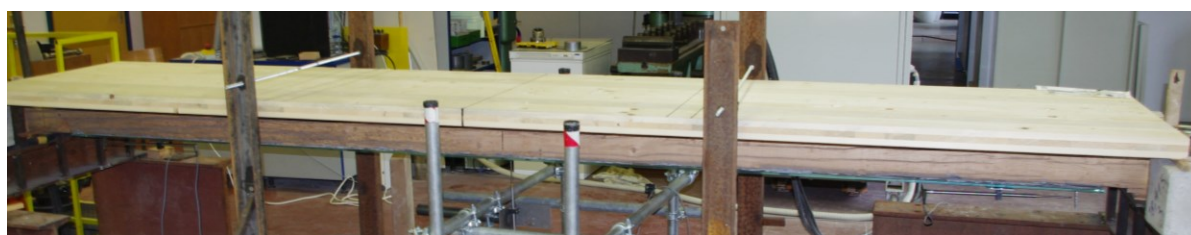
Slika 57: Stropnik 1, konfiguracija A1: sovprežni nosilec CLT-stropnik-steklo
