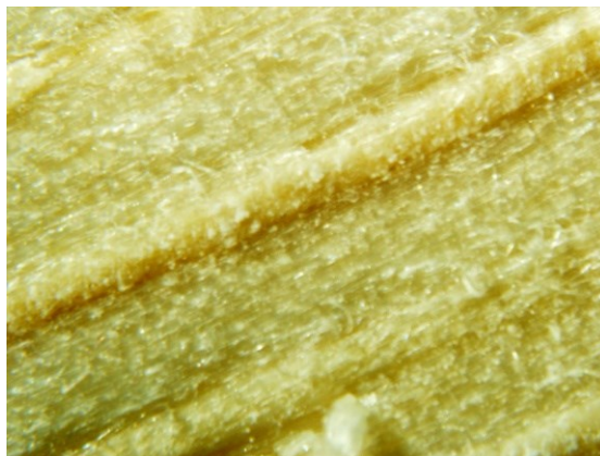
Slika 16: Porušna ploskev na lesenem vzorcu (opazni so »vrhovi« jesenskega lesa)
