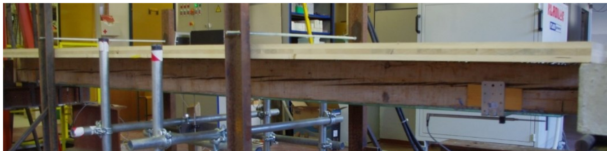
Slika 60: Stropnik 7, konfiguracija A1: sovprežni nosilec CLT-stropnik-steklo
