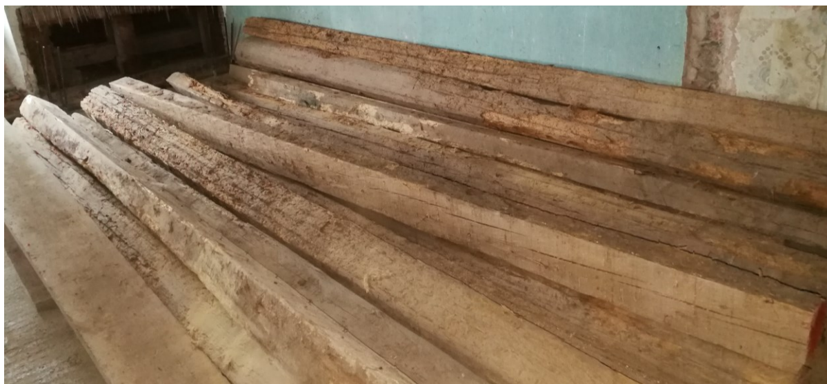
Slika 44: Leseni stropniki z značilnimi sledmi delovanja lesnega črva
