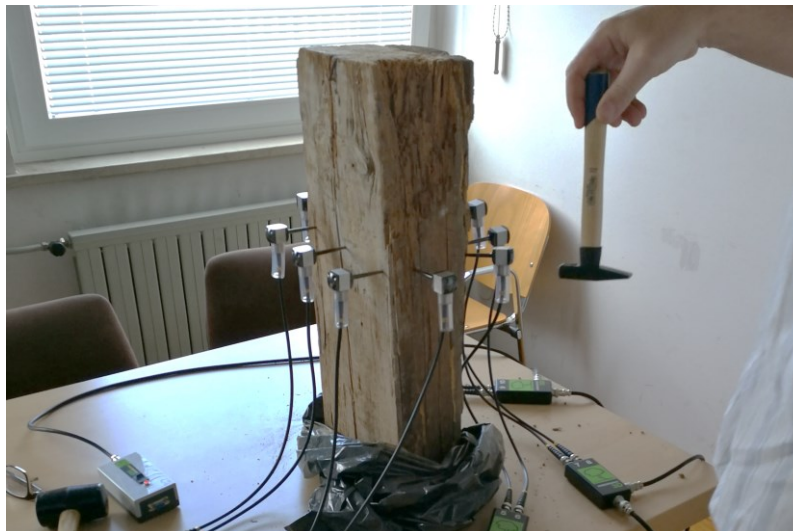
Slika 113: Proizvajanje zvoka s pritrkovanjem po piezoelektričnih senzorjih naprave za akustično tomografijo Fakopp ArborSonic 3D Acoustic Tomograph
