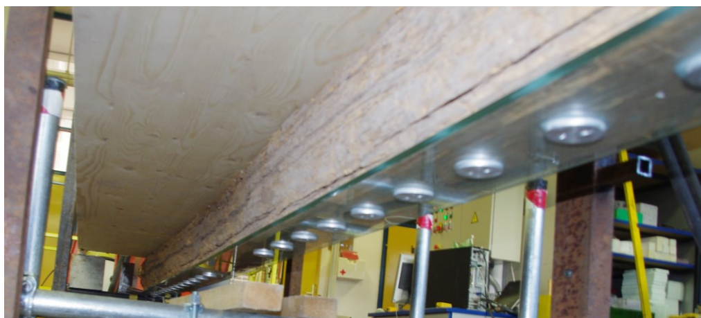
Slika 83: Stropnik 8, konfiguracija A2: sovprežni nosilec CLT-stropnik-steklo
