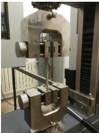
Slika 12: Natezni preizkusi epoksidnih vzorcev
