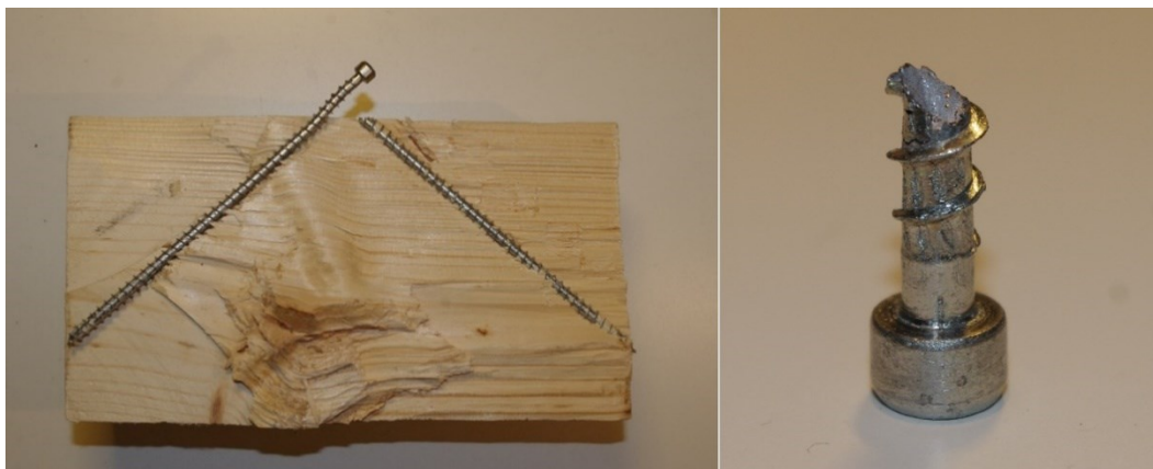
Slika 30: Presek preizkušanca po preizkusu (levo) in pretrgani del strižno in natezno obremenjenega lesnega vijaka (desno)
