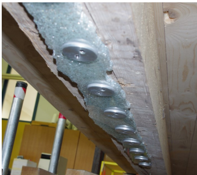
Slika 69: Stropnik 3, konfiguracija B (po upogibnem preizkusu konfiguracije A2)
