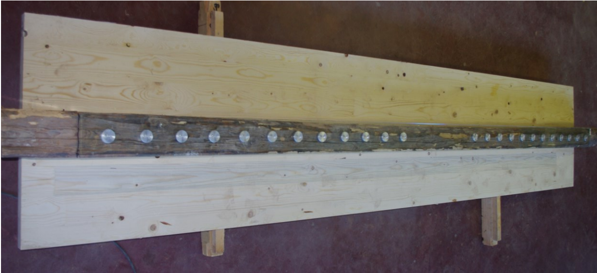
Slika 64: Stropnik 2, konfiguracija A2: sovprežni nosilec CLT-stropnik-steklo
