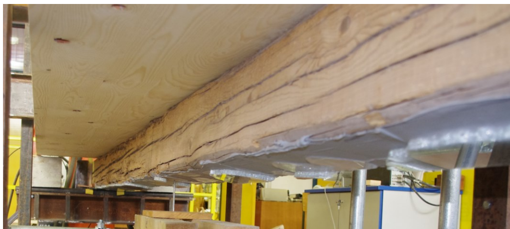
Slika 59: Stropnik 1, konfiguracija B (po upogibnem preizkusu konfiguracije A1)
