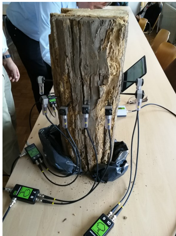
Slika 112: Odžagani konec stropnika z nameščenimi piezoelektričnimi senzorji naprave za akustično tomografijo Fakopp ArborSonic 3D Acoustic Tomograph
