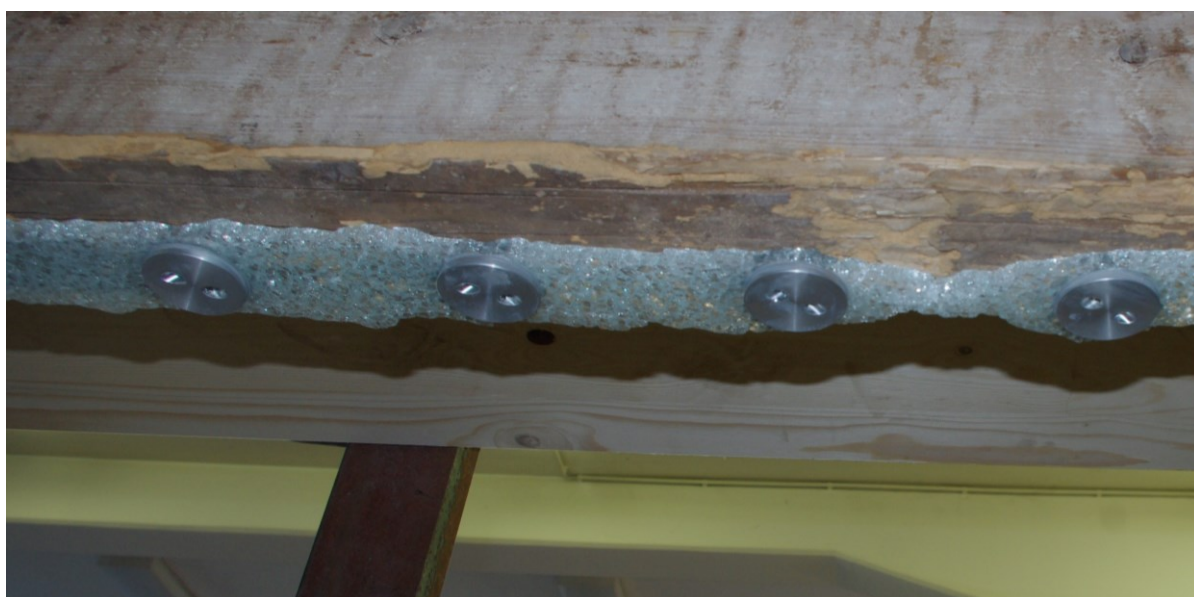
Slika 85: Stropnik 8, konfiguracija B (po upogibnem preizkusu konfiguracije A2)
