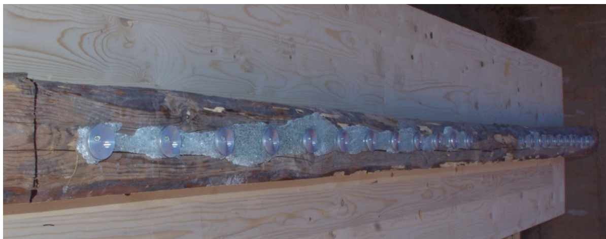
Slika 66: Stropnik 2, konfiguracija B (po upogibnem preizkusu konfiguracije A2)
