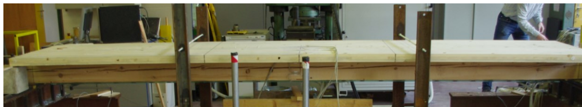
Slika 70: Stropnik 5, konfiguracija A2: sovprežni nosilec CLT-stropnik-steklo
