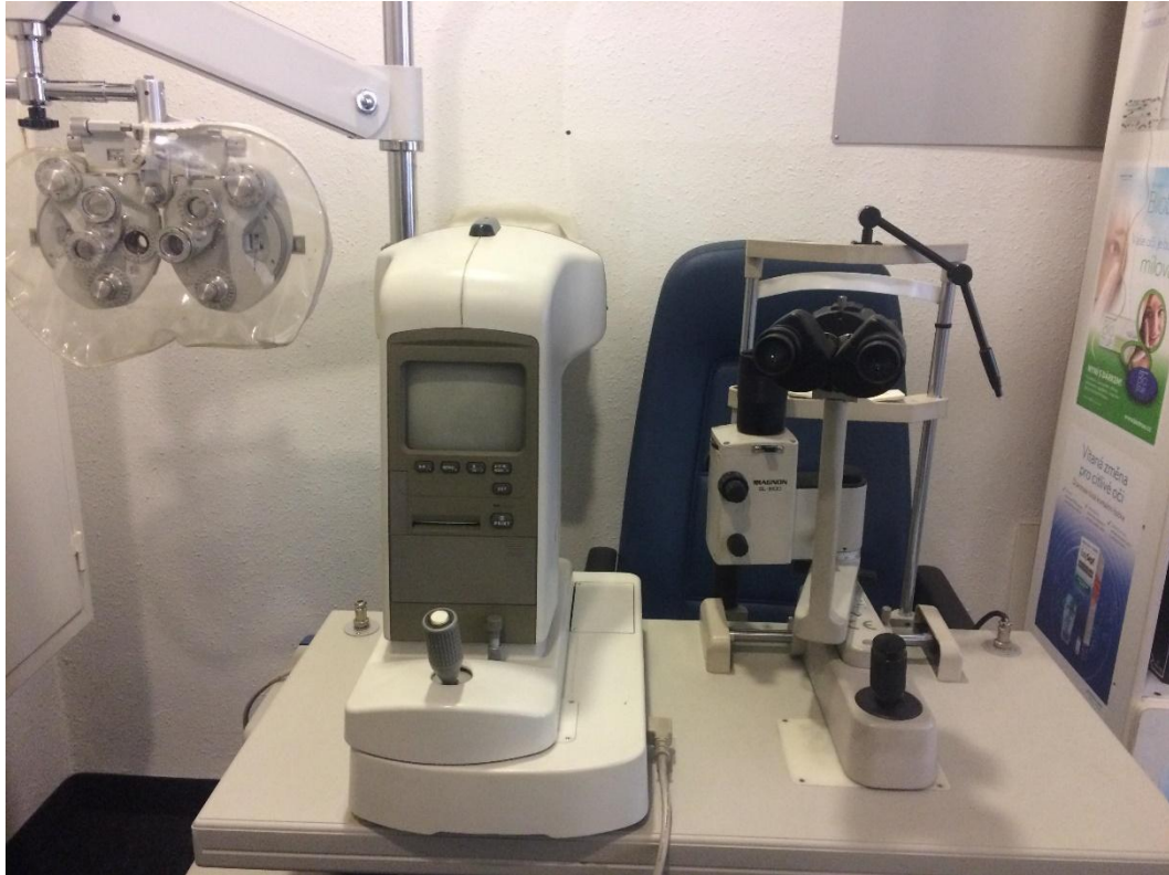
Obrázek 5.15: Posuvný stolek pevně spojený s vyšetřovací jednotkou, na kterém jsou umístěny štěrbinová lampa a autorefraktometr.
