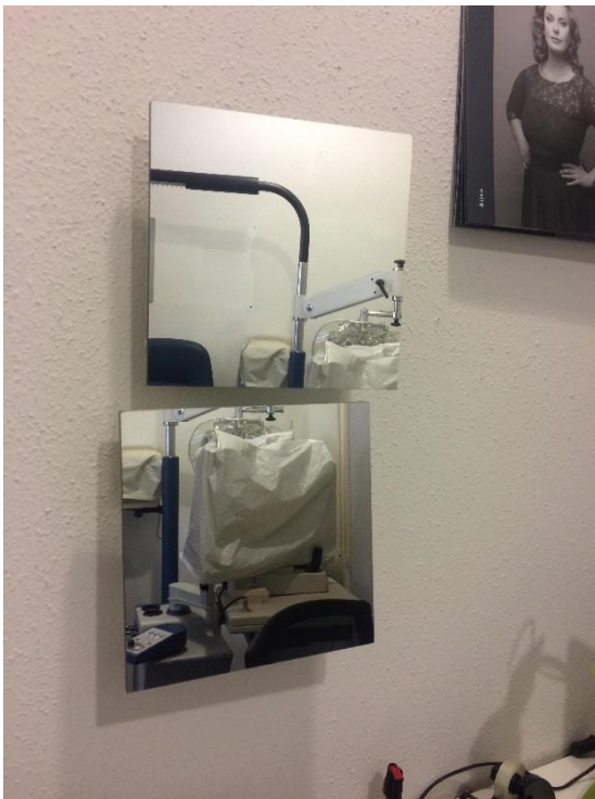
Obrázek 5.16: Zrcadlová soustava pro optické prodloužení místnosti na 6 metrů a náhled na autorefraktometr.
