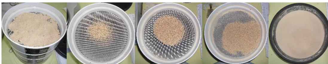
Figura 13. Fotografía de los diferentes pasos en el proceso de tamizado para obtener harinas de diferentes granulometrías.
