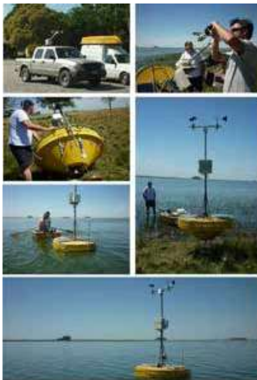
FIGURA 5. VISTA DEL PROCESO DE INSTALACIÓN, RETIRO PARA LIMPIEZA Y REINSTALACIÓN DE LA BOYA “LA BARRANCOSA”.
