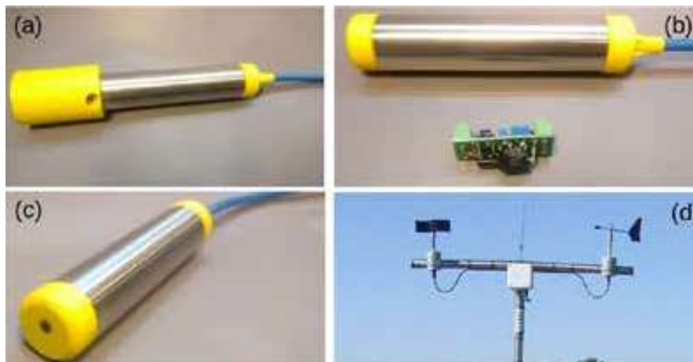
FIGURA 4. VISTA GENERAL DE LOS PRINCIPALES SENSORES. A) CONDUCTIVIDAD Y TEMPERATURA; B) NIVEL DEL AGUA Y TEMPERATURA; C) SEDIMENTOS EN SUSPENSIÓN; Y D) TEMPERATURA DEL AIRE, VELOCIDAD Y DIRECCIÓN DEL VIENTO.
