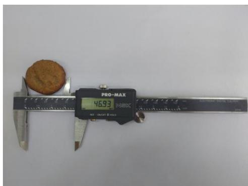
**Figura III.4.** Determinación del diámetro de las galletitas con un calibre digital.
