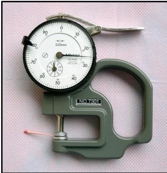
**Figura 2.** Cono #25 .06 medido en el vértice con un espesímetro centesimal.
