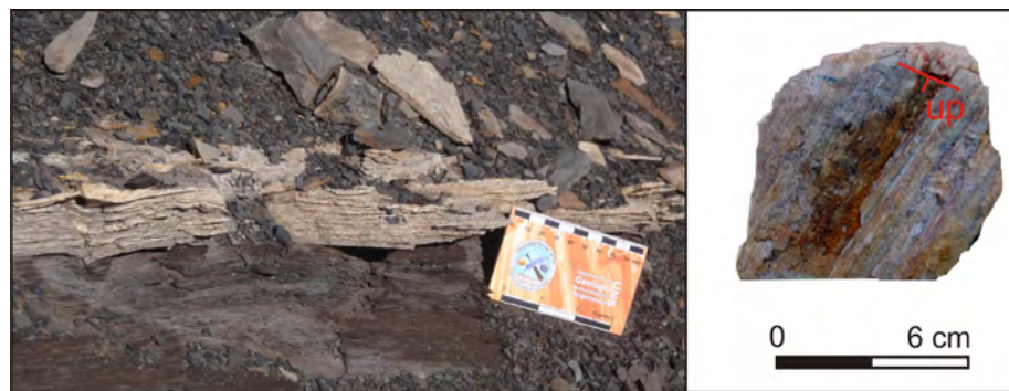
Figura 9. Fractura concordante a la estratificación y cemento asociado. En la imagen de la derecha se observan las estrías asociadas al desplazamiento de la roca de caja sobre el techo de la venilla.
