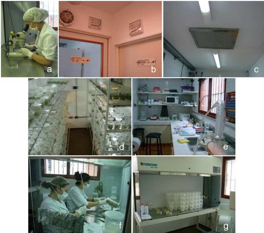
Panel 5: Fotos representativas del laboratorio de micropropagación de BioExt S.A. a: Sector de extracción meristemática bajo lupa de disección, b: puertas de los distintos sectores de presión positiva y filtración HEPA mostrando los manómetros exteriores, c: Filtros HEPA ubicados en los techos de cada sector, d: cámara de plantas in vitro, e: laboratorio de preparación de medios de cultivo, f: flujo laminar horizontal de BioExt utilizado en el proceso de micropropagación, g: dentro del flujo laminar se pueden observar los recipientes plásticos conteniendo el medio de cultivo semisólido necesario para el crecimiento de las plantas in vitro.
