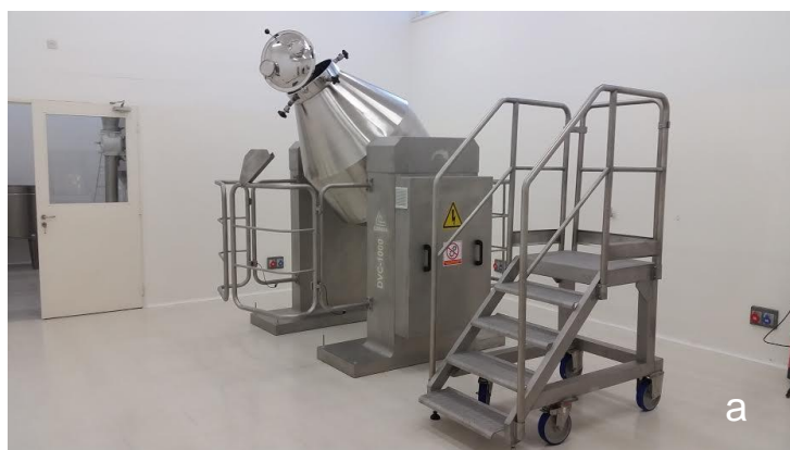
Panel 10: Equipamiento adquirido con el programa EMPRETECNO del FONARSEC (MINCyT). a: Mezcladora doble cono automatizada, b: secador spray.
