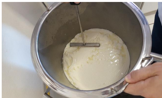
Figura 9 – Processo da primeira mexedura da coalhada com as liras verticais e horizontais
