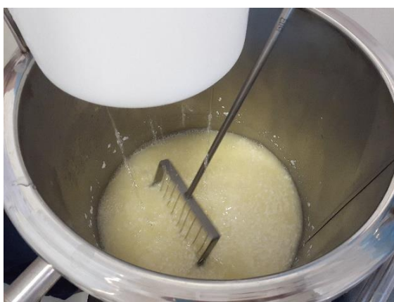
Figura 10 – Processo de dessoragem da coalhada dos queijos
