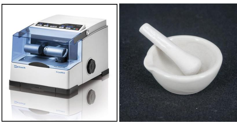
**Figura 17.** Molino de bolas RETSCH Mod.MM301 (izquierda) y mortero (derecha) para la pulverización de muestras óseas.
