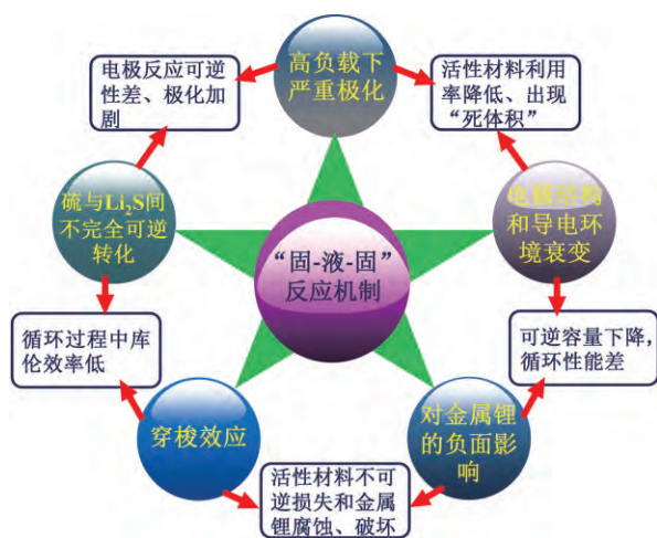
图1 (网络版彩色) 硫正极特殊的“固-液-固”电化学反应历程对锂硫电池电化学性能造成的系列负面影响及其相互关联
