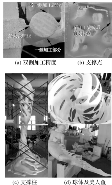
图 6 加工完成的雕塑组件分析及组件拼装
