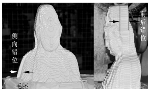
图 1 机器人双侧加工中的误差
