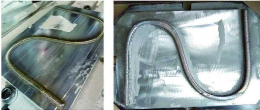
(a) 轮廓偏置算法试验结果 (b) 分区域往复扫描算法试验结果
