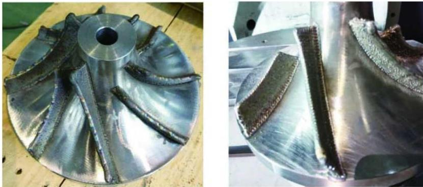
(a) 往复扫描算法方向1 试验结果 (b) 往复扫描算法方向2 试验结果
