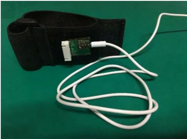
图 2 IMU 传感器模块
