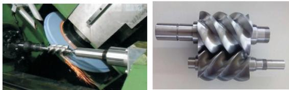
(a) 螺杆转子的磨削过程 (b) 磨削后的转子
