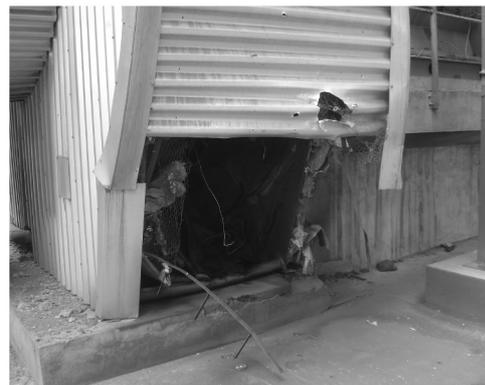
(b) 断裂的叶片造成的事故现场照片
