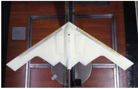
图 2 飞翼布局模型安装图
