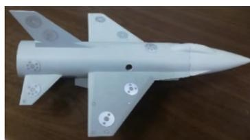
图 5 编码标志点布置方式
