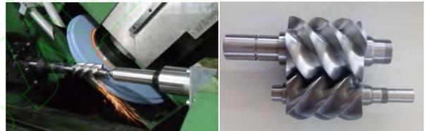
(a) 螺杆转子的磨削过程 (b) 磨削后的转子
