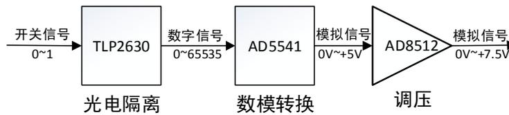
图4 DAC电压设置电路
