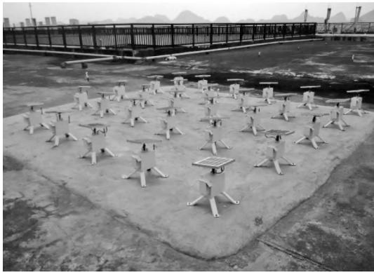
图 6 无线传感网节点安装布置实景图
