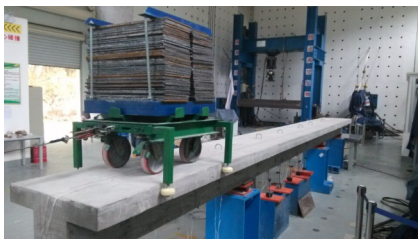
图 3 钢筋混凝土三跨连续梁及试验小车
