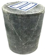
图 2 试样破坏后的形态
