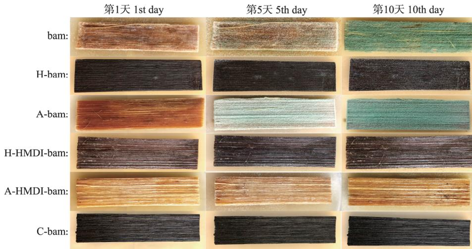
图 4 不同样品腐蚀情况图
