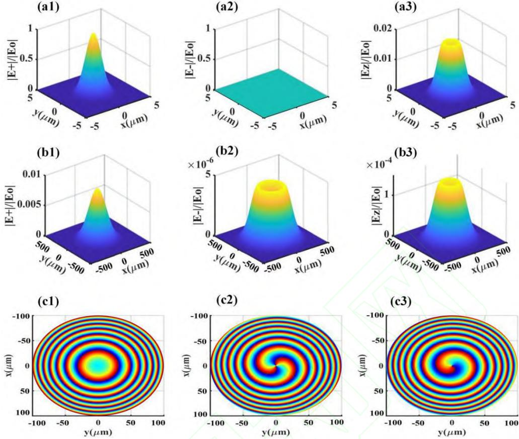
图1 BSO晶体中光电场的振幅和相位分布。(a1-a3)在 $z=0\mu\text{m}$ 平面上 $E_+$ 、 $E_-$ 和 $E_z$ 的振幅分布；(b1-b3)在 $z=3000\mu\text{m}$ 平面上 $E_+$ 、 $E_-$ 和 $E_z$ 的振幅分布；(c1-c3)在 $z=3000\mu\text{m}$ 平面上 $E_+$ 、 $E_-$ 和 $E_z$ 的相位分布
