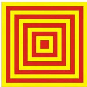
图 3 平面方形线圈结构示意图
