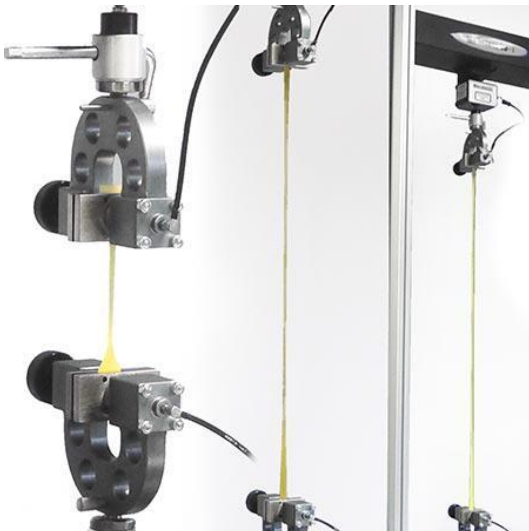
Figura 29. Inicio de la prueba de resistencia a la tracción, progreso y finalización según ASTM D412 (Mecmesin, 2020) (88)
