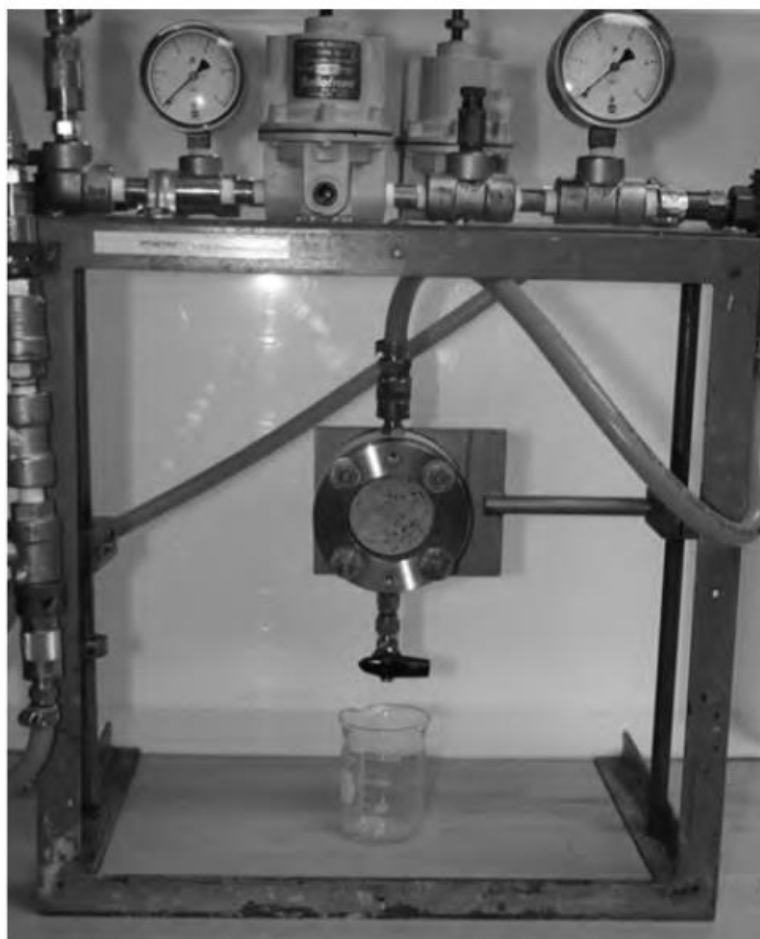
Figura 28. Equipo para ensayo de penetración según ISO 13994 (Ormond & Barker, 2014) (86)
