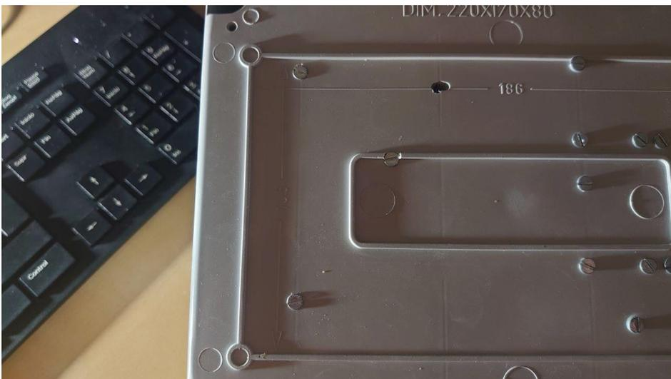
*Ilustración 104 Parte trasera de la caja, 3 tornillos para placa Arduino*
