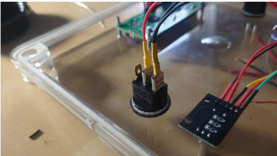
*Il·lustració 115 Interruptor conectado con sus respectivos conectores FASTON y tubo termo retráctil de aislamiento.*
