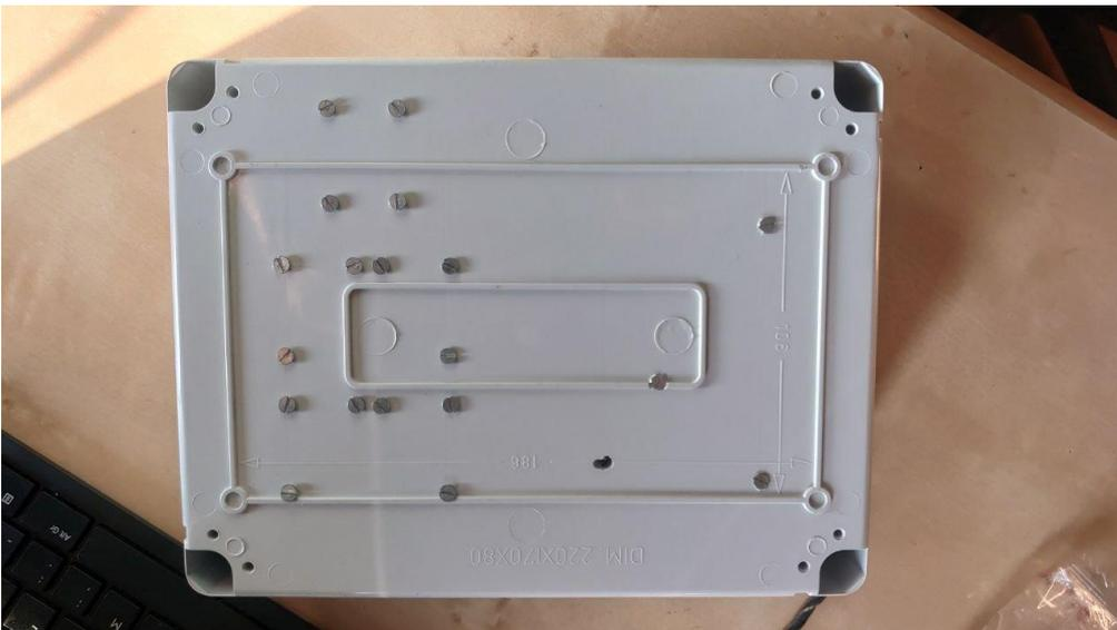
Il·lustració 128 Parte trasera de la caja de componentes con los visos de fijación vistos
