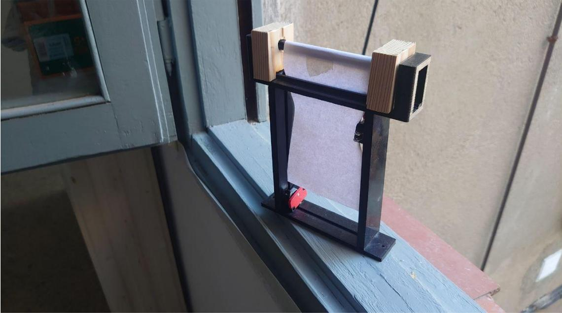
*Il·lustració 80 Estructura de telón con finales de carrera mecanizado*
