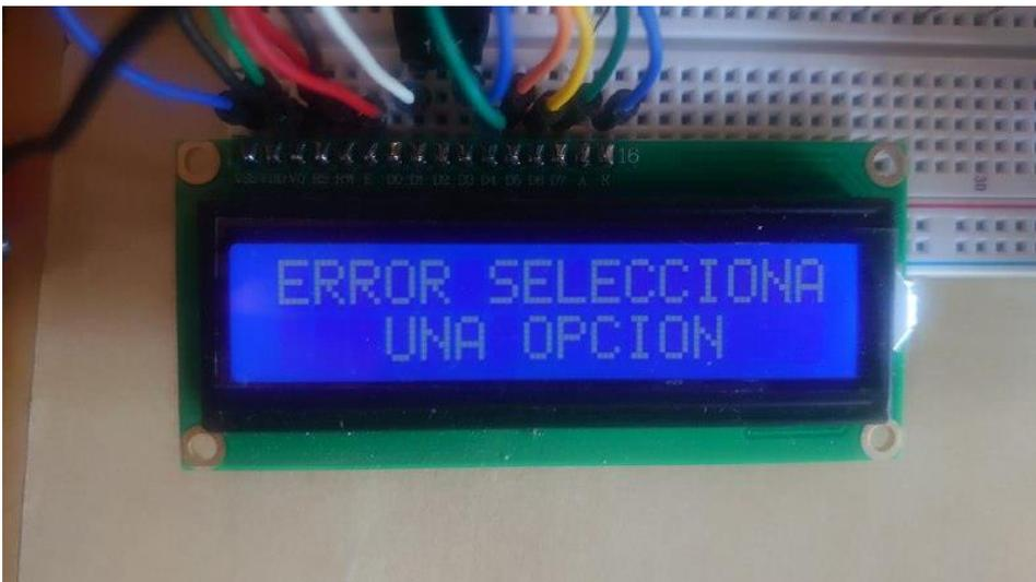
*Ilustración 49 Mensaje de error cuando Manual y Automático están en ON*
