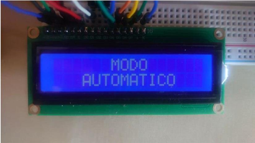
*Il·lustració 56 Mensaje de Arduino indicando Modo Automático*
