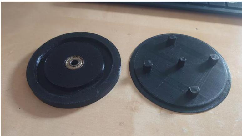
*Il·lustració 75 Plataforma giratoria abierta donde se observa el rodamiento ABEC-6*
