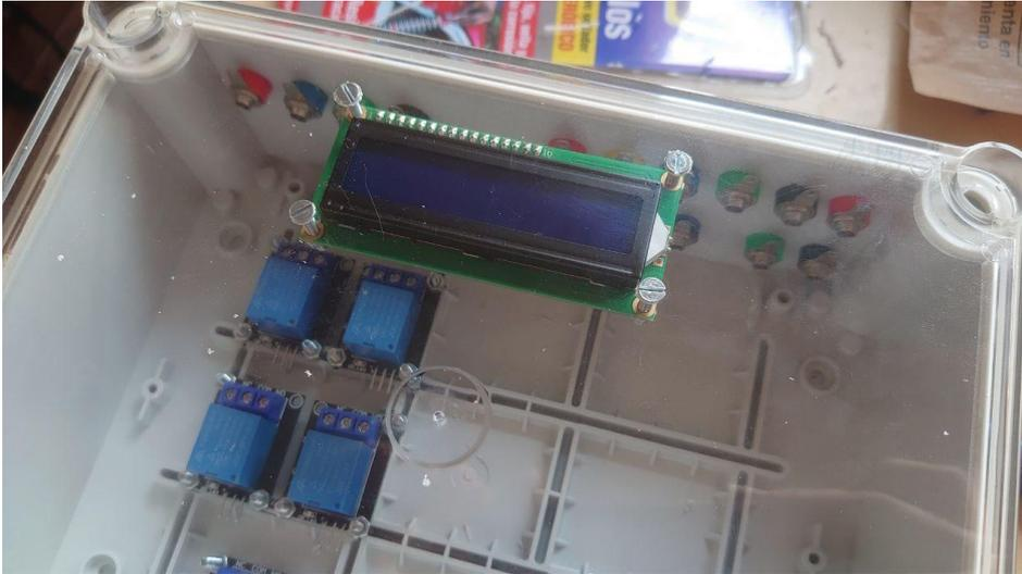
*Ilustración 93 Instalación de LCD en parte frontal*
