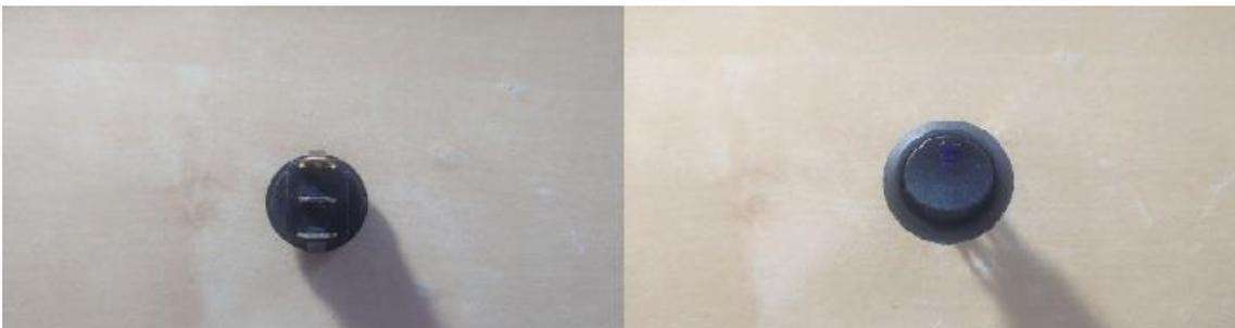
Ilustración 33 Interruptor tipo KCD1-8
