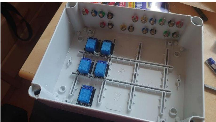
*Il·lustració 92 Relés completamente instalados*
