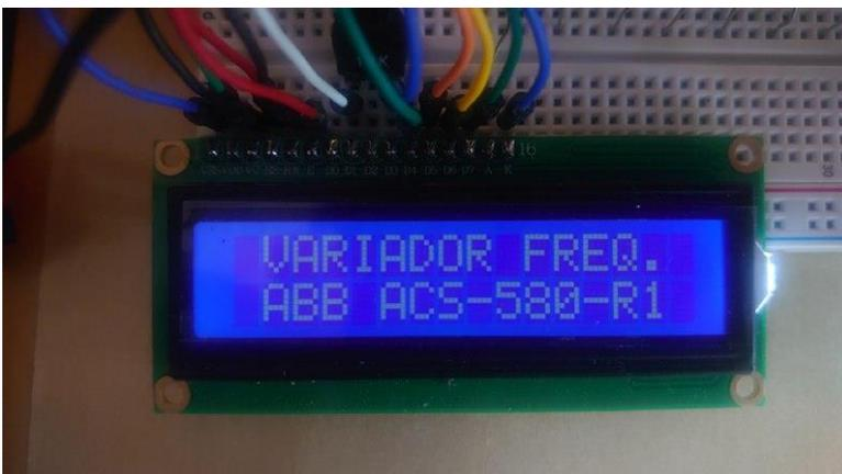
*Ilustración 51 Mensaje de Variador de frecuencia cuando manual y automático se encuentran en OFF*
