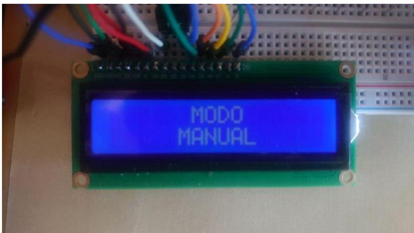
*Ilustración 52 Mensaje que muestra Arduino para indicar que se trabaja en Modo Manual*
