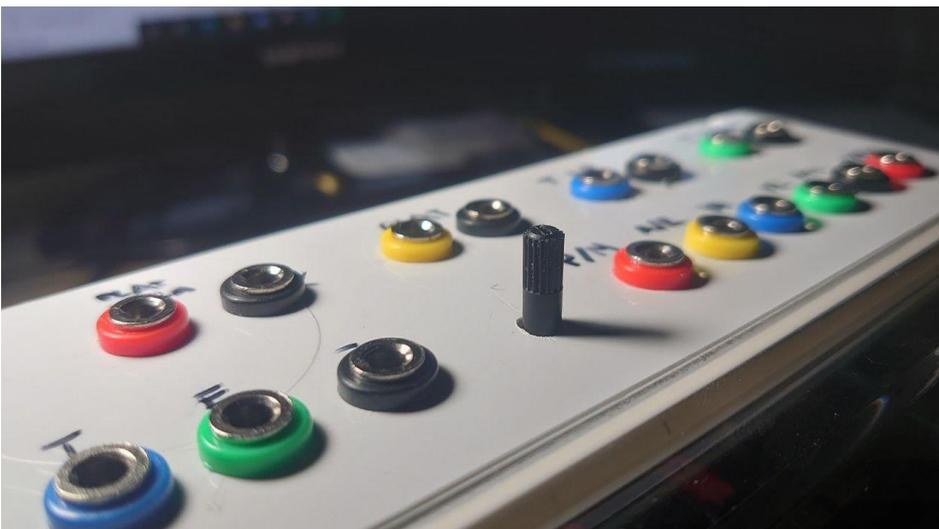
*Ilustración 102 Potenciómetro de 10 k para la retroiluminación de la pantalla*
