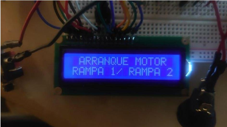
*Il·lustració 53 Mensaje por pantalla de submenú Rampa1/Rampa 2 en Modo Manual*
