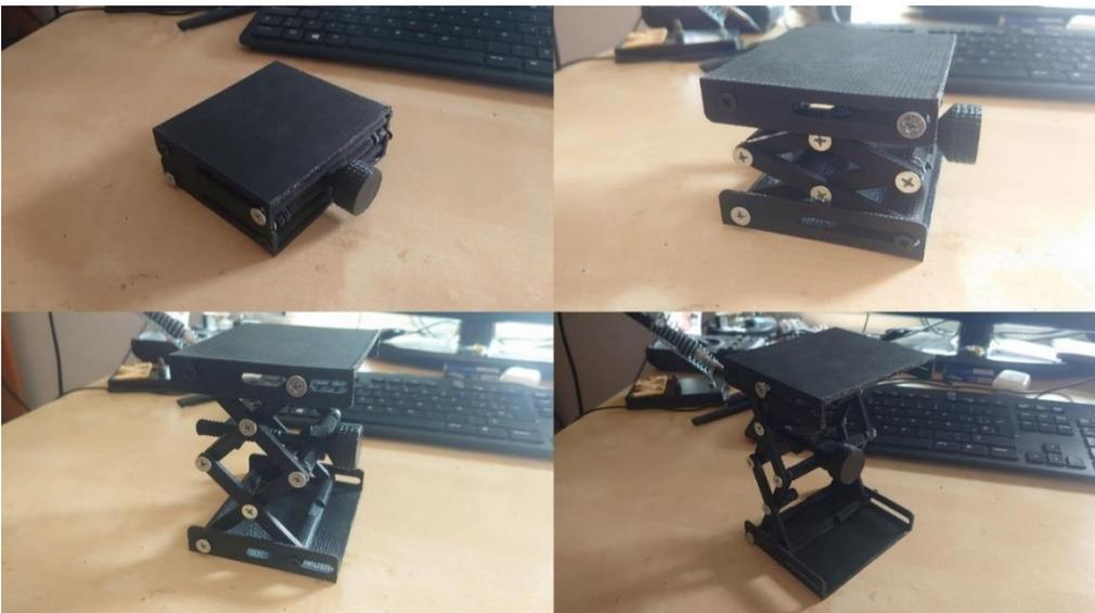
*Ilustración 77 Diferentes posiciones de la plataforma consiguiendo diferentes alturas*
