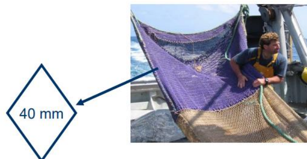
Figura 13. Quadrícula de la malla en forma de diamant de 40 mm. Font: Bahamon, N., Barcelona, UB, 2008
