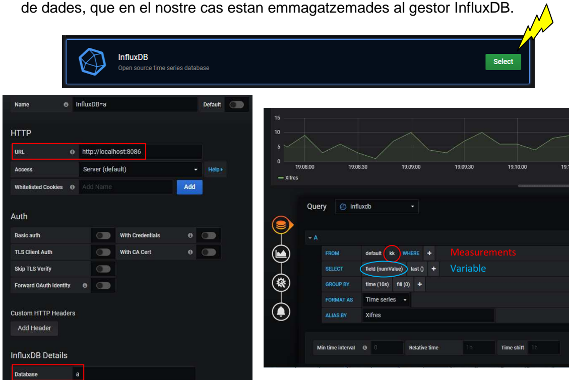
Figura 61: Configuració font de dades Influx i posterior visualització amb Grafana
