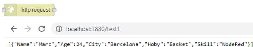
Figura 46: Node Http request i visualització a través d'una direcció URL
