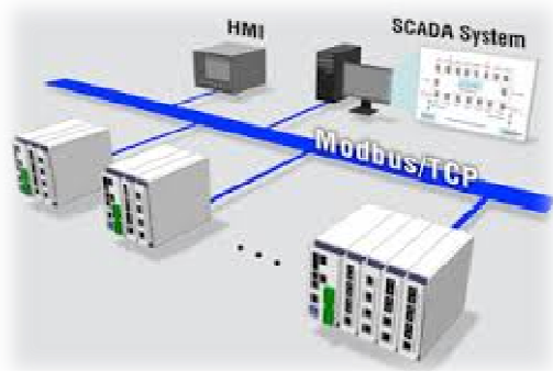
Figura 7: Connexió Modbus entre PLCs
