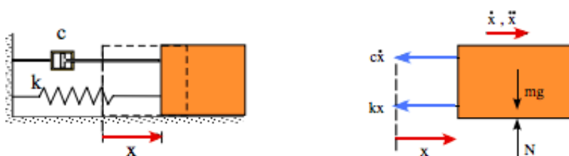
Figura 4: Ejemplo de vibración libre
