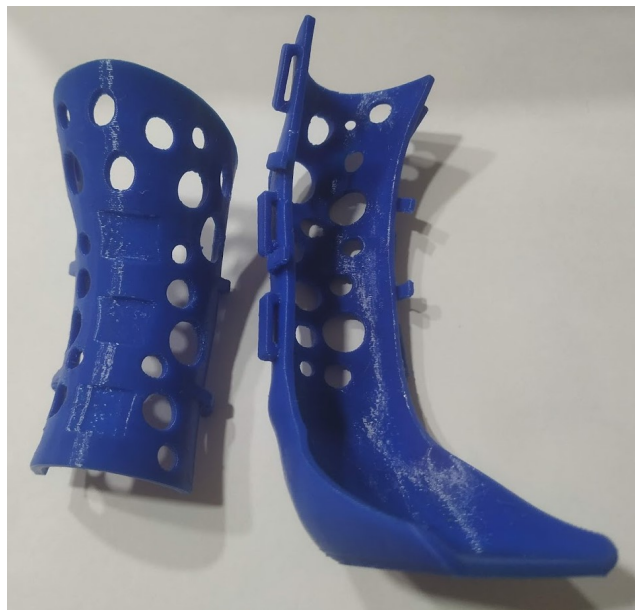
Figura 73: Parts de la fèrula de la pota posterior impreses en PLA
