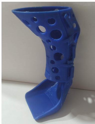
Figura 74: Parts de la fèrula de la pota posterior encaixades Font: Elaboració pròpia
