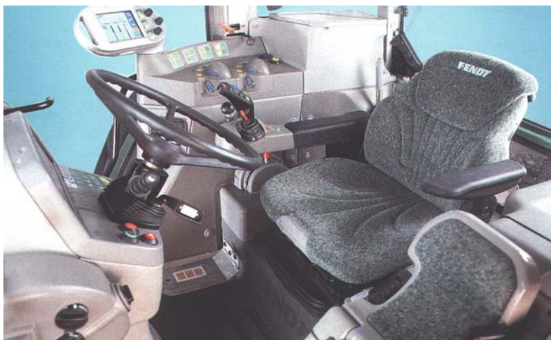
Figura 24. Sistema de integración del mando de equipos accionados LBS-CAN-BUS en los tractores FENDT 700 y 900 V.
