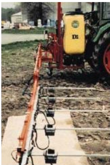
Figura 14. Pulverizador Detectspray equipado con sensores ópticos para la detección de malas hierbas
