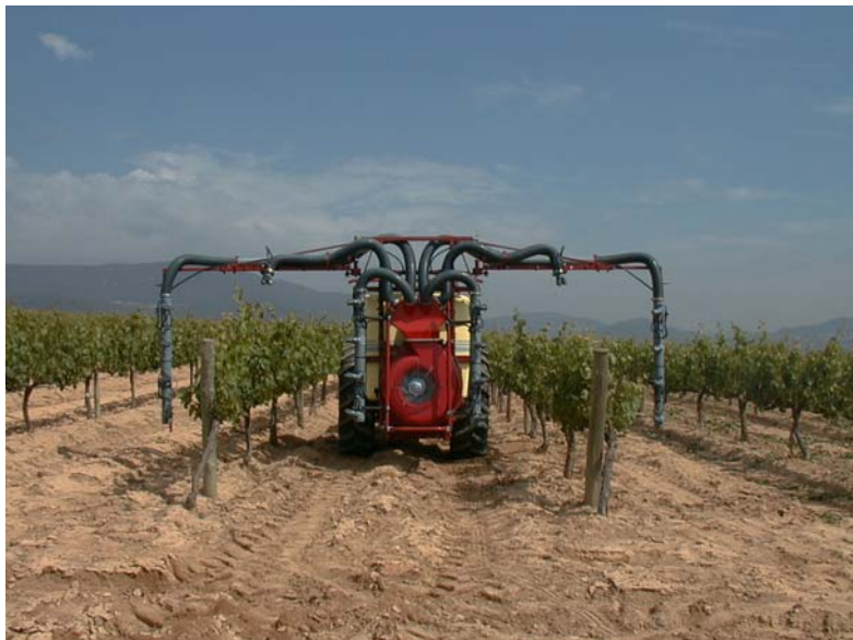
Figura 22. La aplicación modular de fitosanitarios en viña debe permitir la adaptación de la dosis a las características cambiantes de la vegetación.
