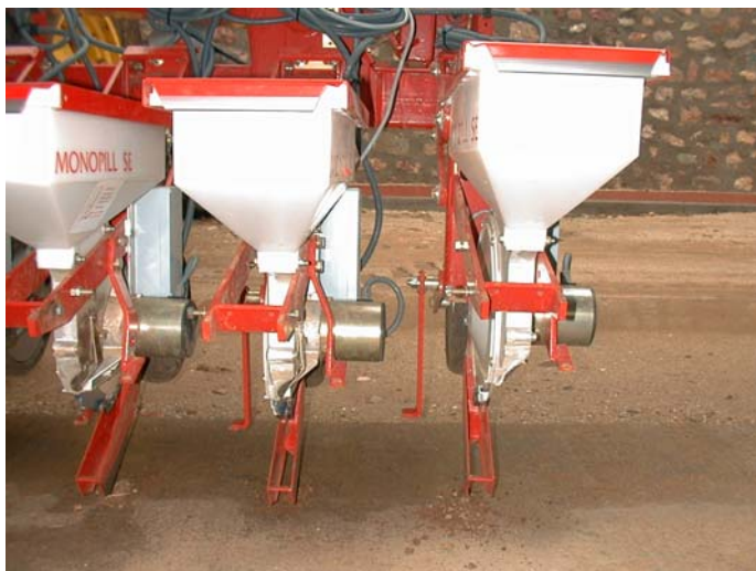
Figura 18. Sembradora monograno mecánica Kverneland Monopill equipada con motores eléctricos independientes en cada disco de siembra que permiten la modulación individual de la densidad de semillas.
