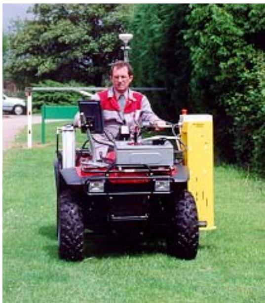
Figura 8. Tractor equipado con sonda para la toma de muestras de suelo y receptor de señal DGPS. (fotografía del autor)
