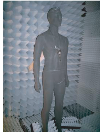
図 1 レーダイメージング実験に用いた人体模型 [17] Fig. 1 Mannequin and handgun used in the radar imaging experiment [17].
