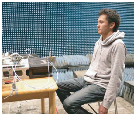
図 7 非接触心拍計測のためのレーダ測定風景 [27] Fig. 7 Noncontact radar measurement of the human heartbeat [27].
