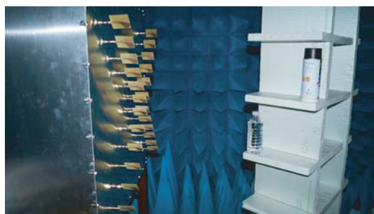
図3 アレーアンテナと多モードキャビティによる測定システムと目標（スプレー缶とペットボトル） [19]
