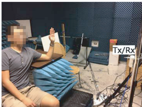
図 13 ジェスチャー自動識別技術を実証するための 2.4 GHz ドップラレーダ実験風景 [40]
