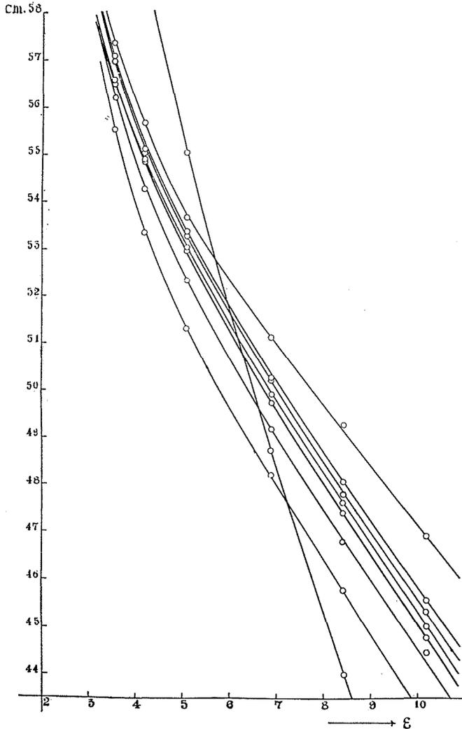
Die Beziehung zwischen der Dielektrizitätskonstanten und dem Anorthit-Gehalte ist der Reihe nach in fast der gleichen Weise, wie man es in Fig. 10 sieht, in Fig. 11 dargestellt, worin die dreieckig markierten Punkte den aus den anderen Proben (Oligoklas von Nord Carolina und Andesin von Iki, Japan) erhaltenen Beziehungen entsprechen.
