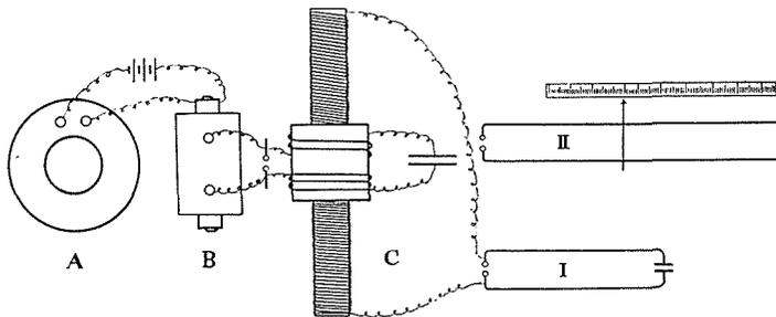
Ein Primärkreis I besteht aus einem Kondensator, zwei in 3.5 cm. Entfernung parallel zueinander stehenden 0.2 cm. dicken Lei-
