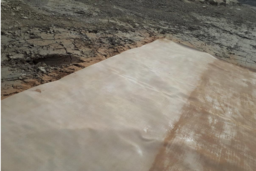
Kuva 19. Laminoidun bentoniittimaton pinnalle jää irtonaista bentoniittijauhetta. (Leppänen 2019)
