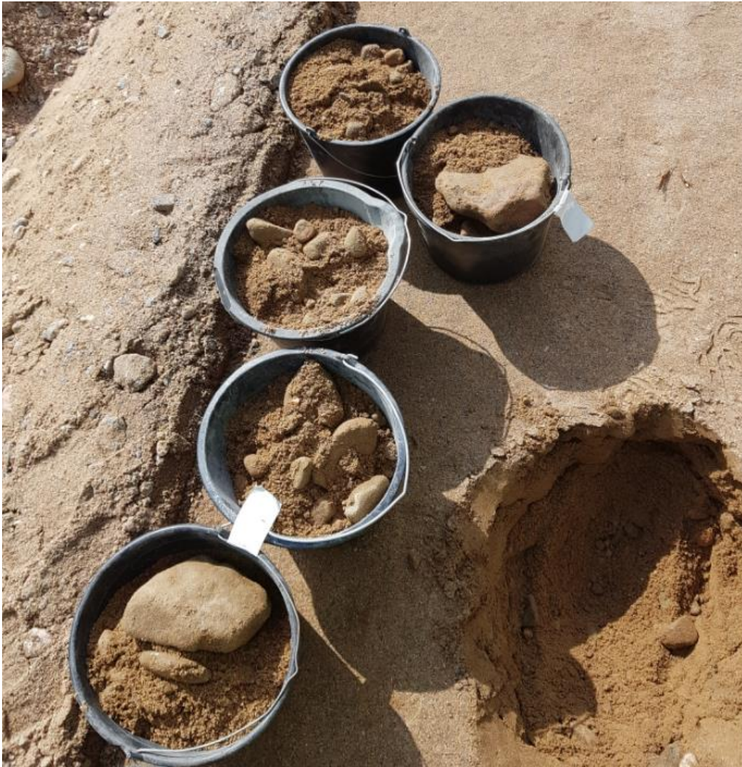
Kuva 22. Luonnonsorasta rakennetun välikerroksen pinnalta otettu osanäyte, jossa oli suuria rakeita.
