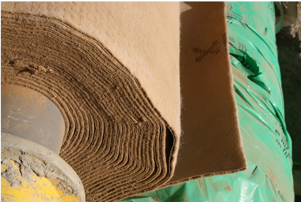
Kuva 16. Laminoitun bentoniittimaton rakenne. (Leppänen 2019)
