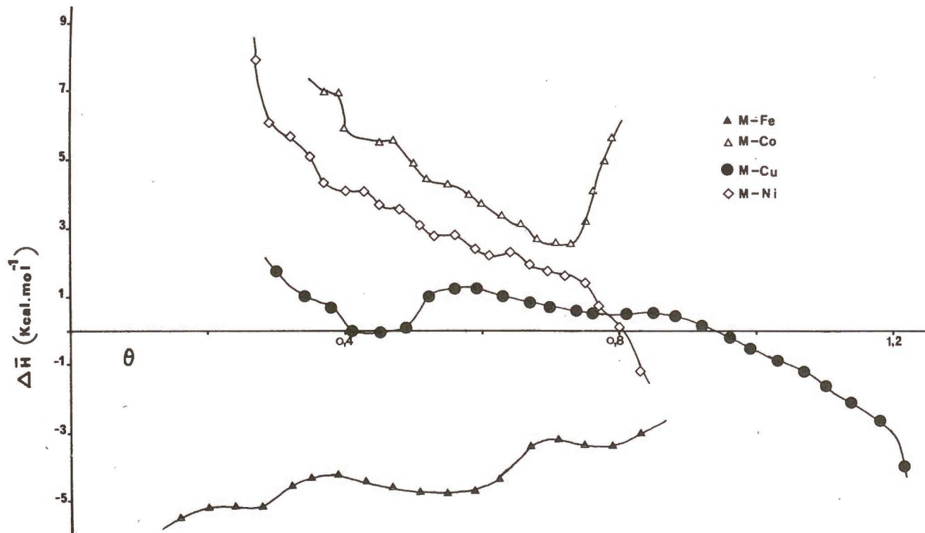
FIG. 6.- Variación de los calores diferenciales de retención del metoxicloro sobre M-Fe, M-Co, M-Ni y M-Cu frente a la fracción de cubrimiento.
