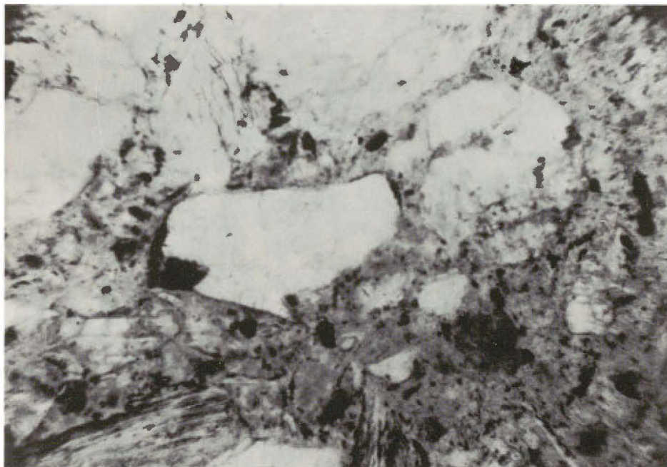
FOTO 1.— Saprolita granítica: los granos resistentes aparecen densamente empaquetados entre otros más o menos argilizados. Distribución relacionada porfiriosquelética (L.N. x 40).
