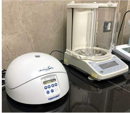
*Figura 2 Microcentrífuga MiniSpin Y balanza analítica.*
